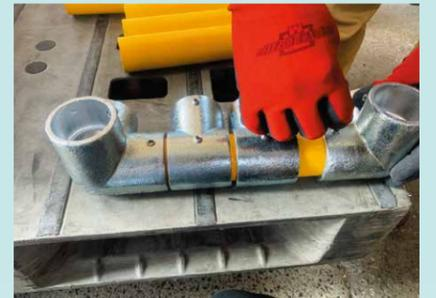
③枠組みを作成していきます。綺麗に作成できるように最初は“仮止め”をすることがポイントです。
