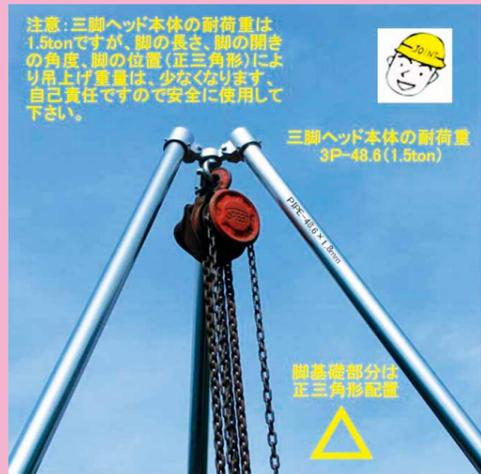
設置の要点と三脚ヘッドとチェーンブロックのセット写真
