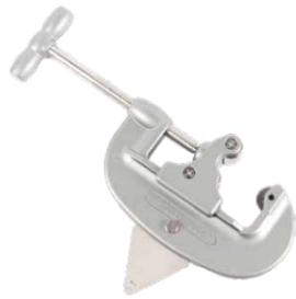
〈パイプカッターの特徴〉スチール製の単管はもちろん、銅・アルミ・ステンレス・塩ビ等のためのパイプ等をスムーズにカットすることが出来るパイプカッターです。回すだけで簡単に切ることが出来るため、力のない方でも扱えます。高速カッター等の電動工具より音も静かです。用途も幅広い為、使えるようになっておくと非常に便利です。
