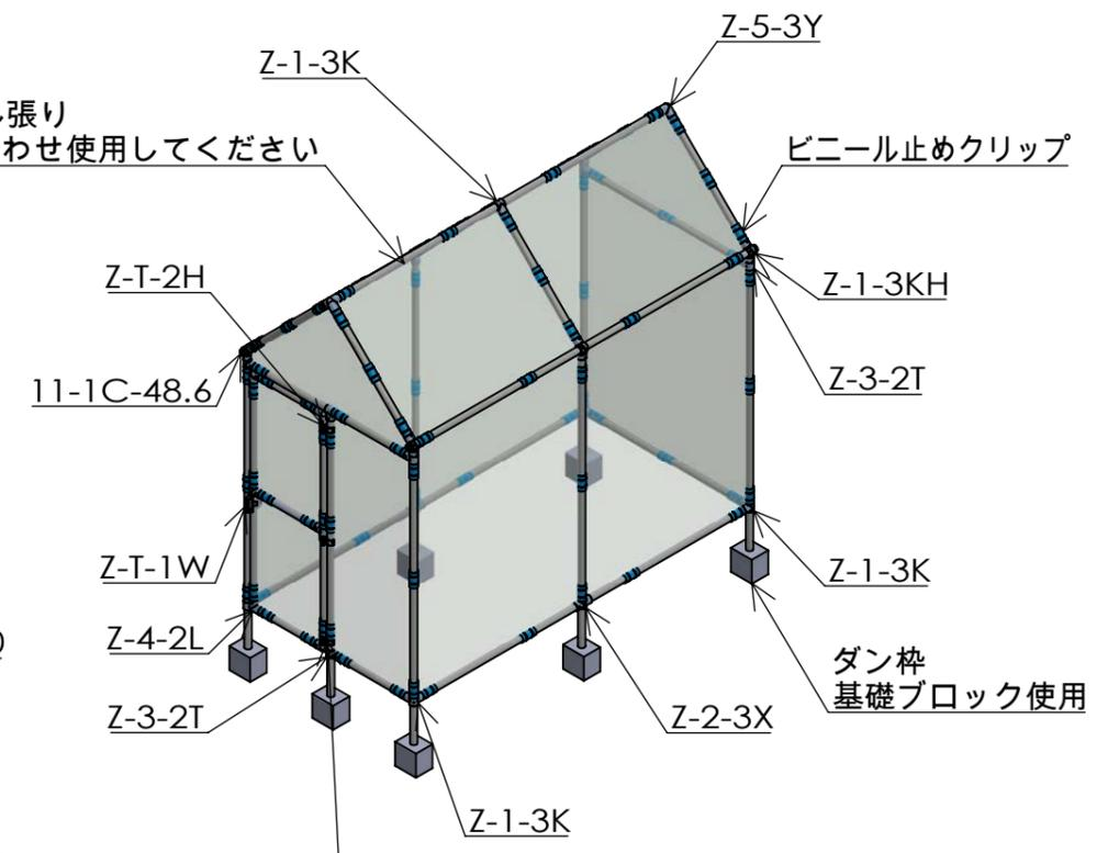
クリップの間隔取り付け位置は扉可動部・構造物の寸法を考慮して配置してください。(あくまで作図上一例の配置・数量)
